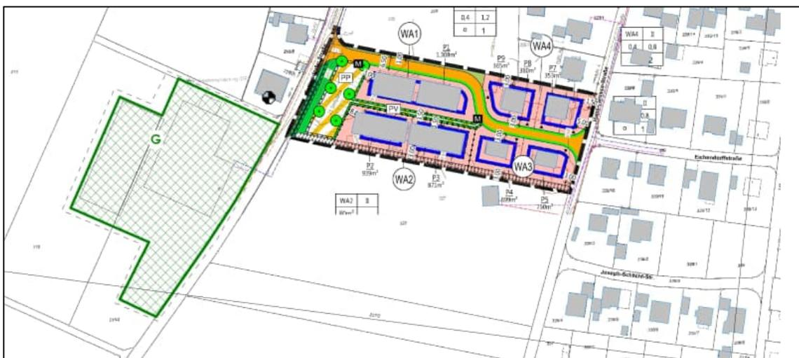
Abbildung 4: Lageplan mit Darstellung der berücksichtigten Emissionsbezugsfläche und des maßgeblichen Immissionsortes
