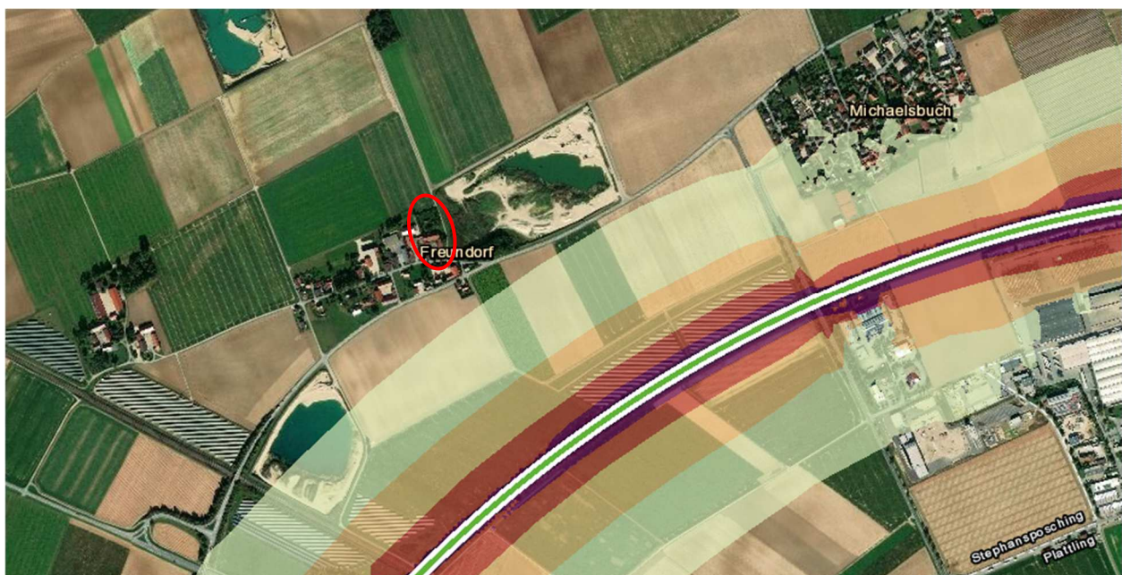
Abb. 8: Lärmimmissionen durch die südlich von Freundorf gelegene Bundesautobahn A92, welche an Plattling vorbeiführt, Ausschnitt o. M (Plangebiet rot umrandet)
